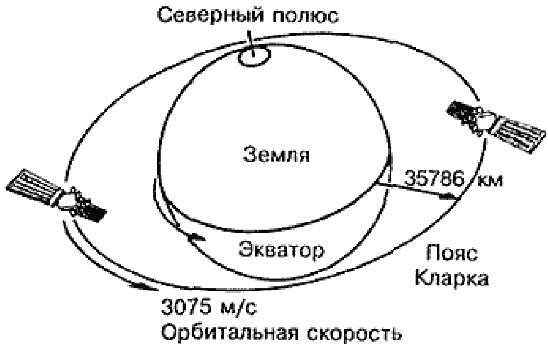
Рисунок 6.1 – Геостационарная круговая орбита ИСЗ
