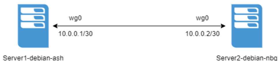
Рис. 3.5. Топологія «точка-точка» для розгортання VPN WireGuard на серверах з ОС Debian 10
