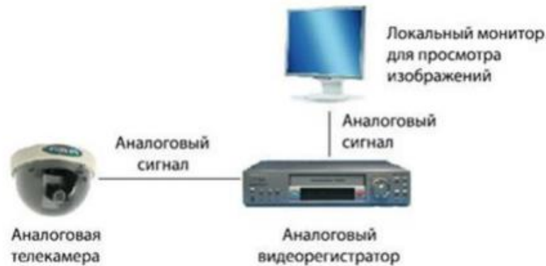
Рисунок 1.3 – Схема конструкції аналогової системи відеоспостереження
