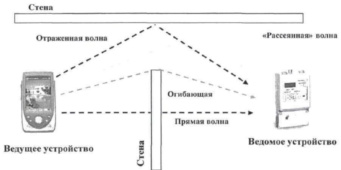
Малюнок 6 - Модель багатопроменевого поширення радіохвиль [50]
