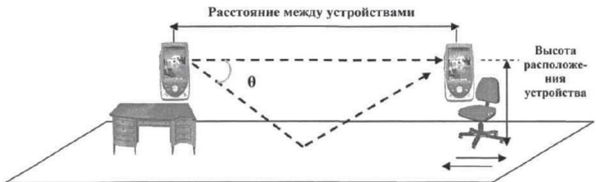
Малюнок 8 - Розташування УМРД в приміщенні в проекції[50].
