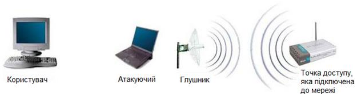
Рис. 2.4 Атака глушіння базової станції для перехоплення з'єднання
