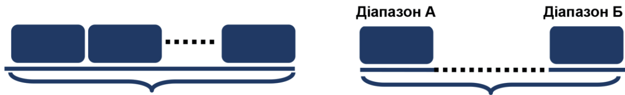
Рис. 1.8 Агрегація спектру: a — агрегація несучих частот (сумарна ширина смуги до 100 МГц); б — агрегація смуг на рознесених частотах
