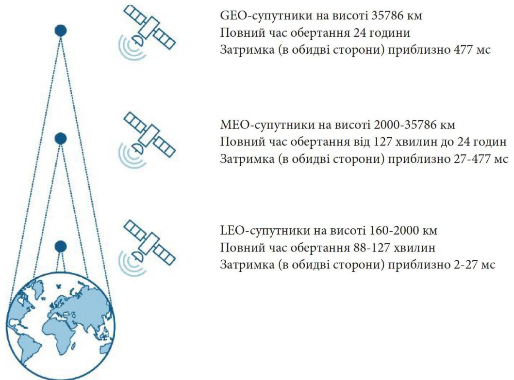
Рис.1.1. Порівняння за покриттям GEO, MEO, LEO
