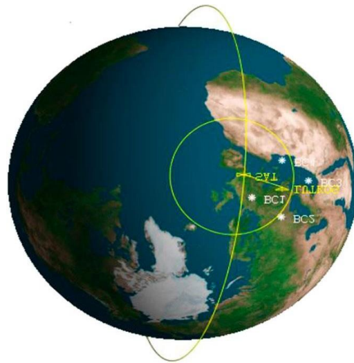
Рис.3.4. Змодельована зона покриття супутника LEO
