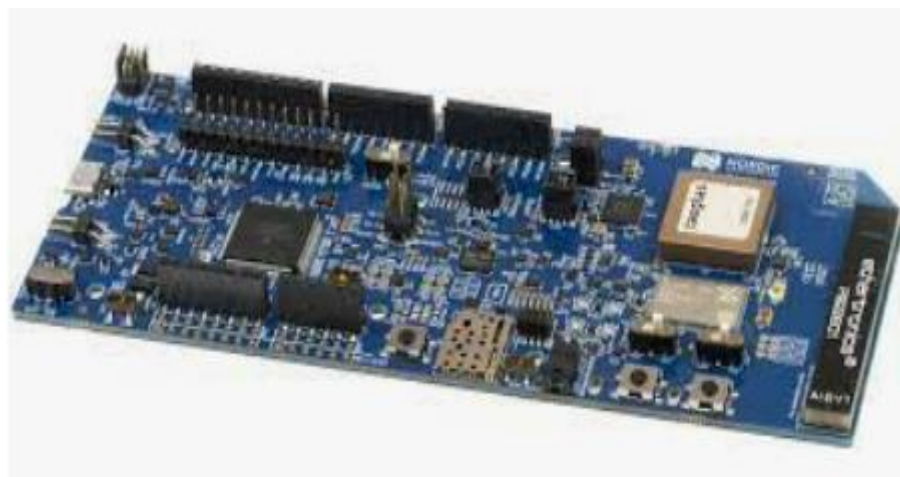
Рис.2.1. SiP малої потужності з вбудованим модемом LTE-M/NB-IoT і GNSS
