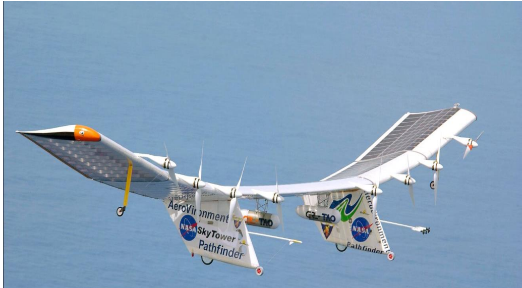
Рис. 1.4 Атмосферний супутник, як різновид БПЛА від NASA
