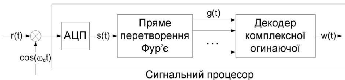
Рисунок 1.20. Функціональна схема приймача OFDM
