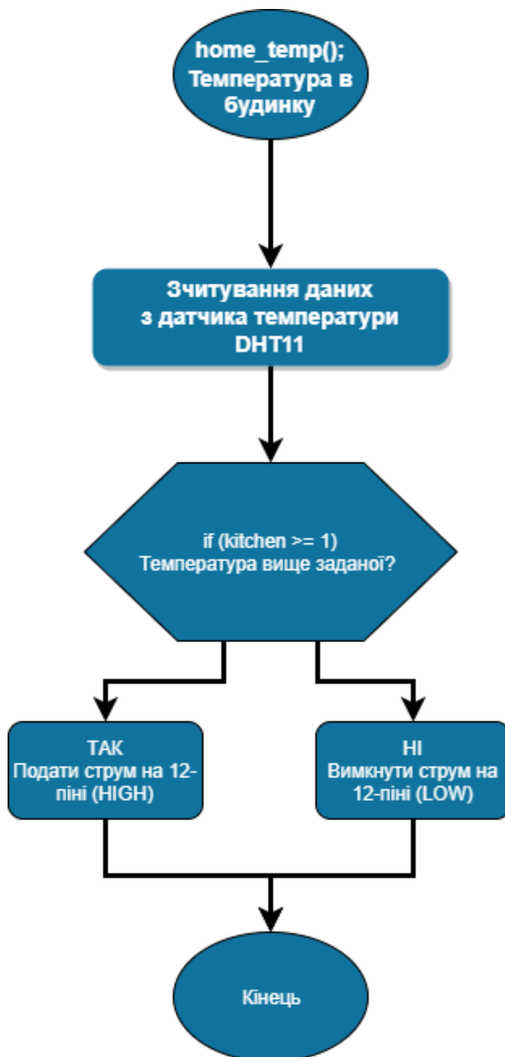
Рисунок 3.2. Алгоритм програми звукового сповіщення при підвищенні норми температури в будинку
