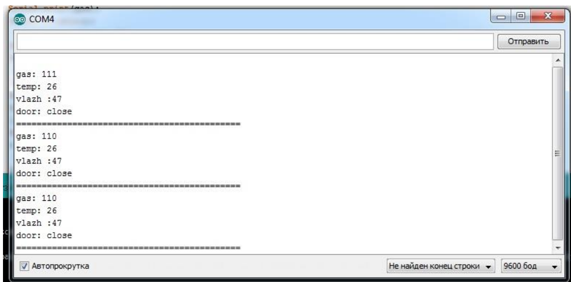
Рисунок 3.12. Вивід показників датчиків в Serial Monitor Arduino
