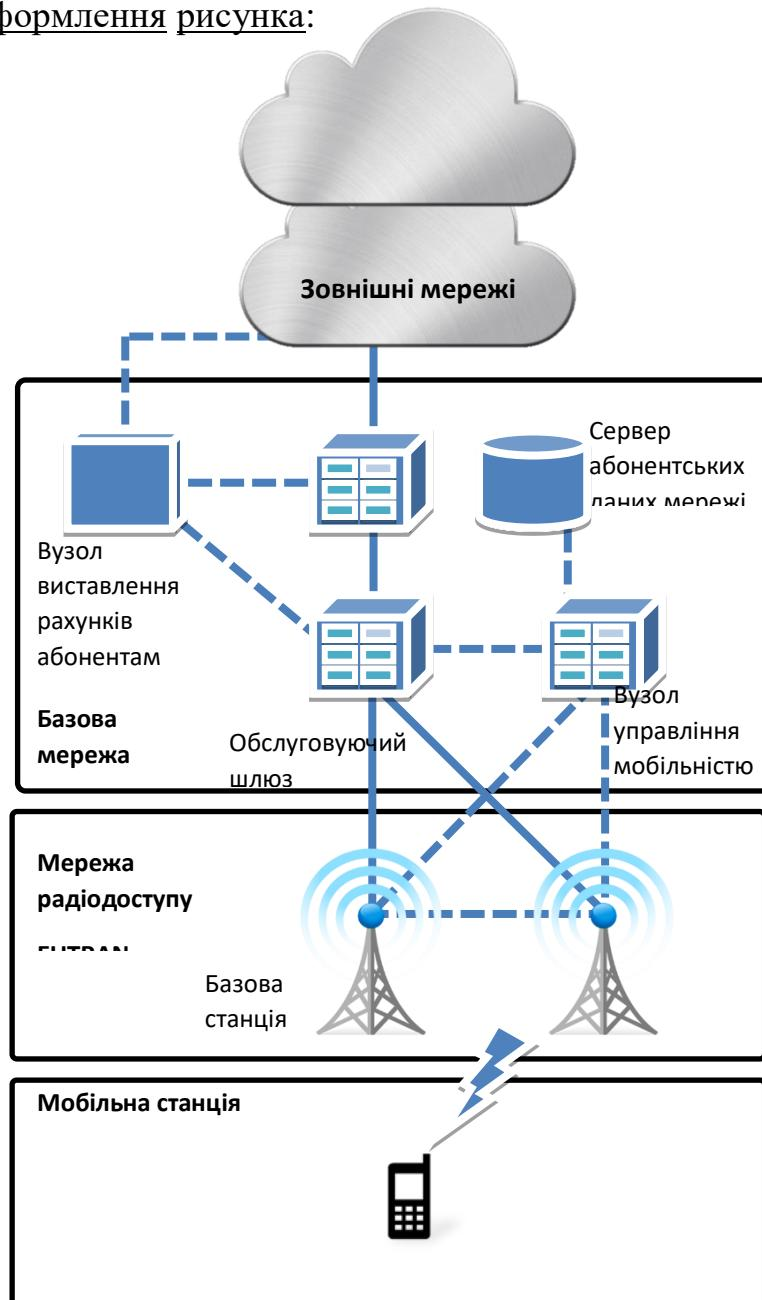
Рисунок 1.3 – Структурна схема мережі LTE
